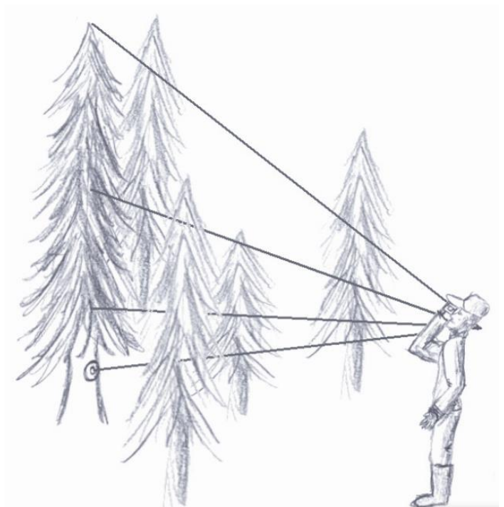
Hình 04. Đo chiều cao vút ngọn của cây bằng thước đo cao Vertex
