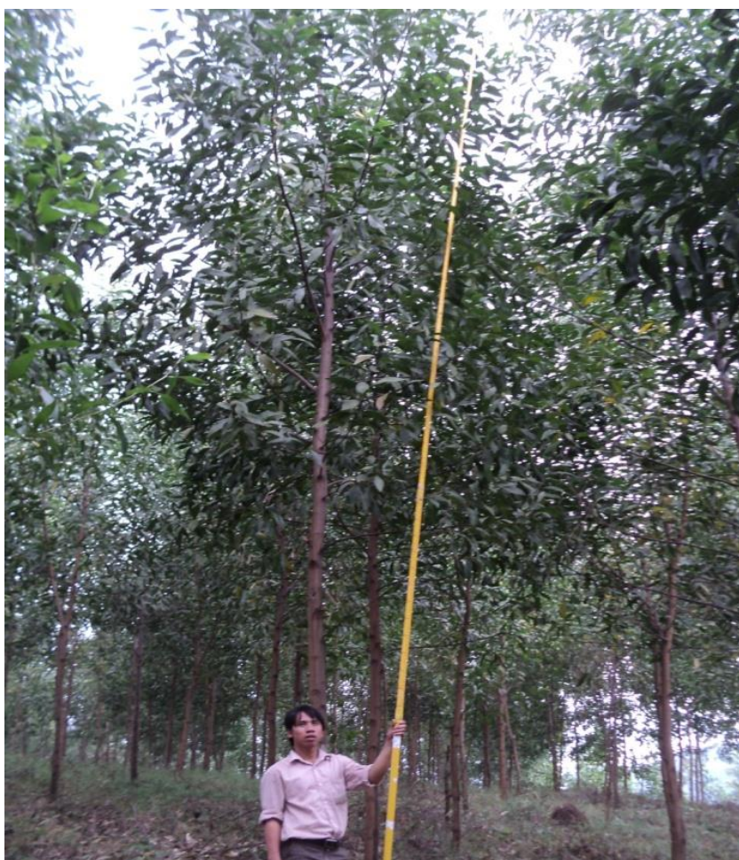
Hình 05. Đo chiều cao vút ngọn của cây bằng sào đo cao
