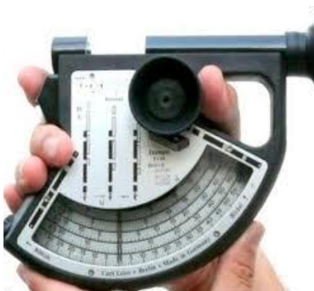
Hình 03. Đo chiều cao vút ngọn của cây bằng thước đo cao Blume - leiss
